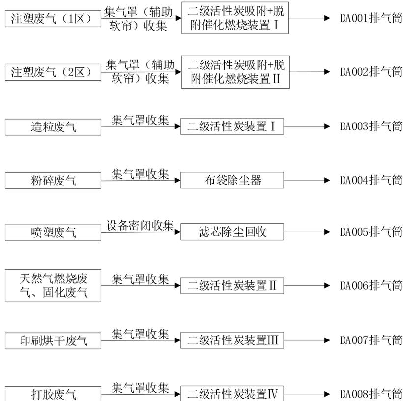
图 6.1-1 项目废气收集处理情况示意图
