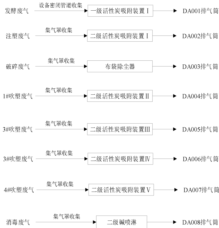
图 7.1-1 建设项目废气收集处理情况示意图
